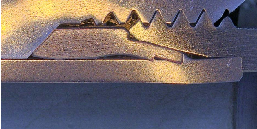
7: Estremità deformata tubo VOSSForm- del tubo BENTELER ZISTAPLEX
