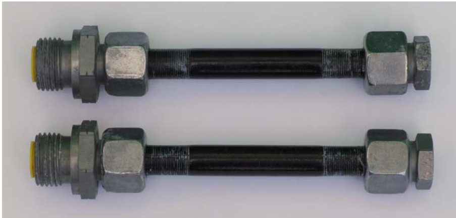
4: VOSSForm-Oggetto testato con prova di resistenza alla nebbia salina
