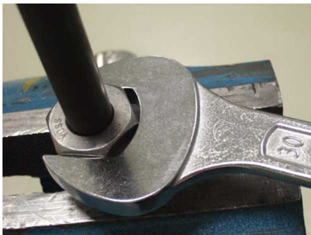
2: Danni al rivestimento di protezione contro la corrosione dopo operazione di montaggio
