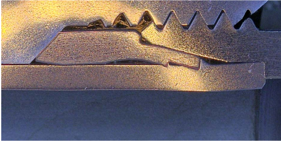
6: Coupe correcte de la bague coupante dans le tube
