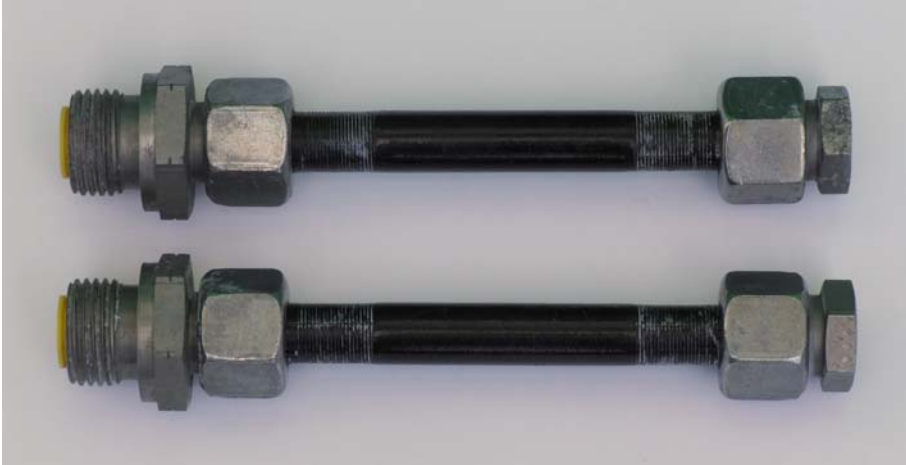
4: Échantillons VOSS Form après essai au brouillard salin
