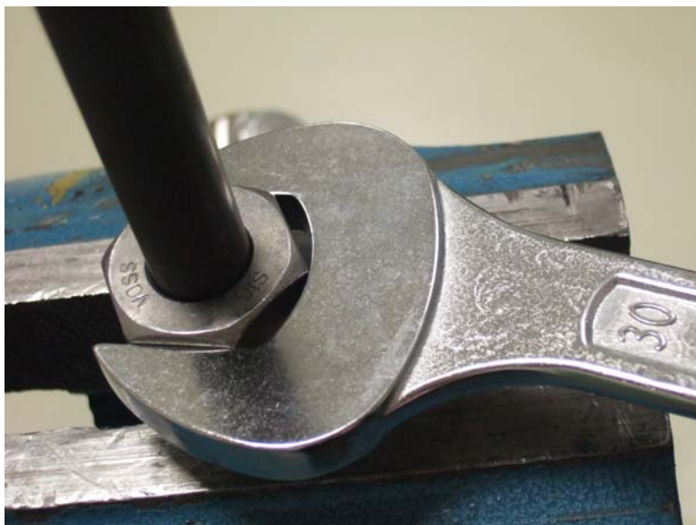
2: Dommages sur la couche anti-corrosion lors de l'assemblage final
