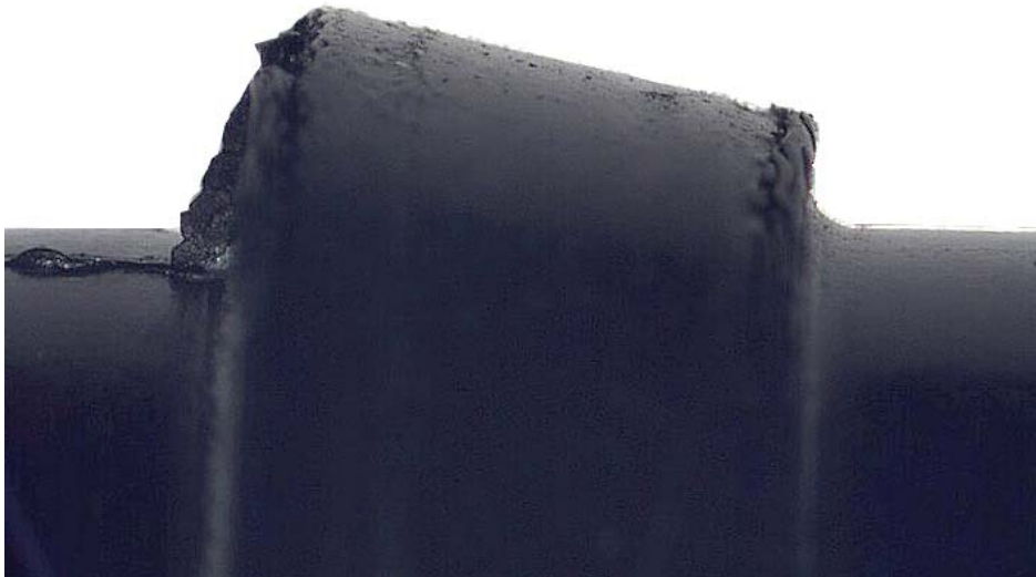
7: Extrémité de tube formée VOSS Form du tube BENTELER ZISTAPLEX
