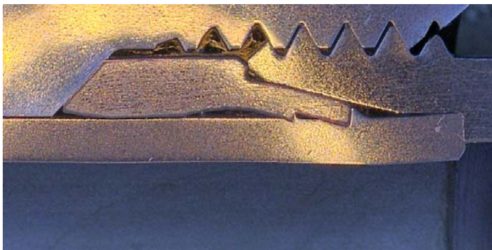
6: Incisión correcta del anillo cortante en el tubo
