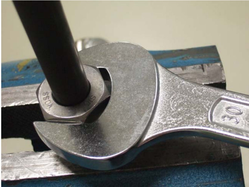
2: Daños en el revestimiento de protección contra la corrosión causados por el proceso de montaje final
