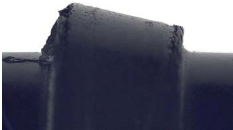
7: Extremo de tubo conformado con VOSSForm del tubo BENTELE ZISTAPLEX
